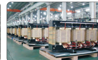
特种变压器及电抗器类产品 Special Transformer & Reactor 月产能: 40万kVA Monthly Output: 400 Thousand kVA
