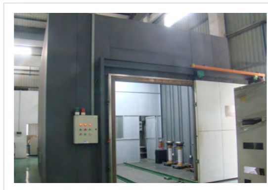
部分放電試験専用シールドルーム(背景環境: 1pC以下)
