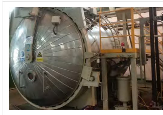
真空注型設備(2台)
